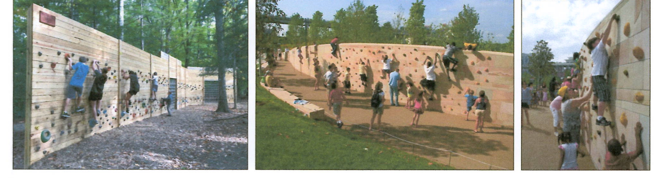
Z.1.1. Perete catarare pentru adolescenti si tineri - Modele orientative de pereti de catarare. Inaltimea peretelui va fi de aprox. 2.50 - 3.50 m si va fi configurat pentru a.i. sa se poata realiza un traseu de catarare pe toata lungimea acestuia .
